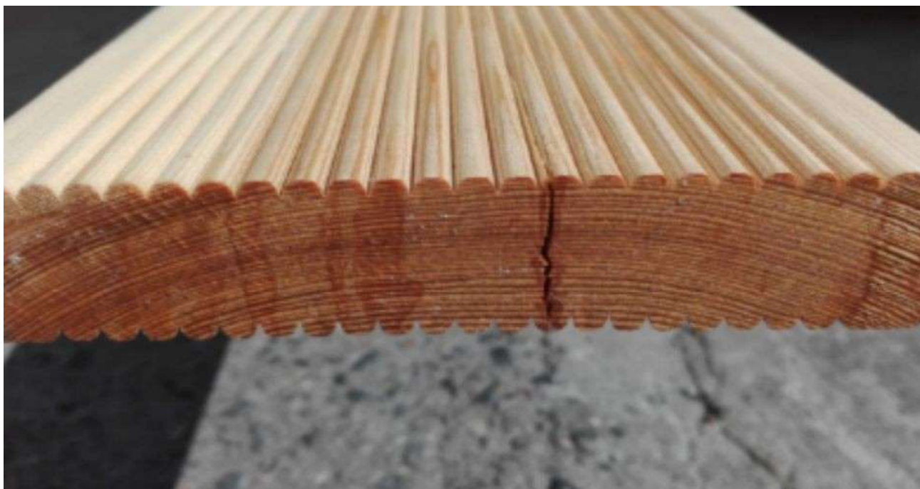
Foto 18 – ein frontal gelegener, durchlaufender Riss
