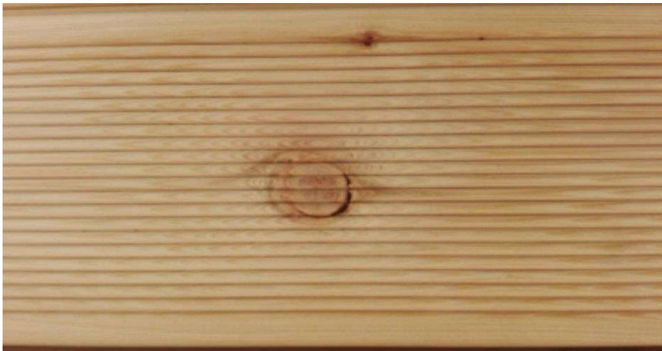
Foto 17 – Ast mit einer schwarzen Hülle eingewachsen im Teilkreis
