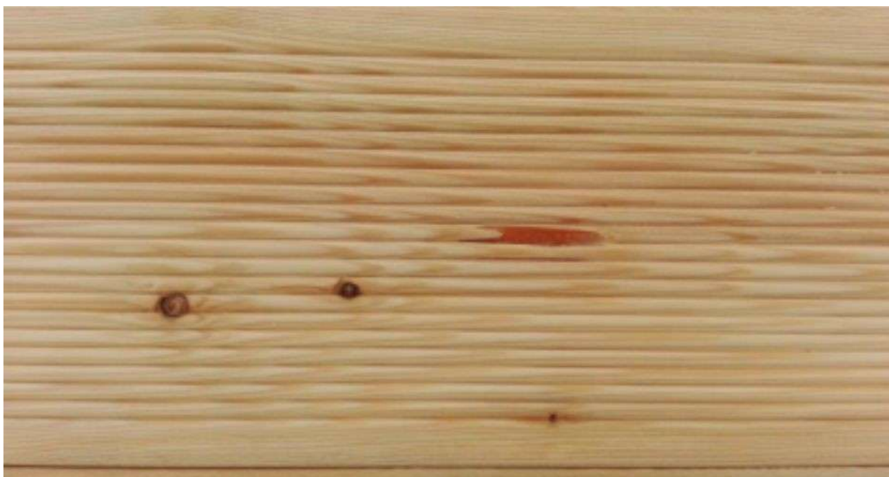
Foto 10 - Äste in Bleistiftform, Harzkammer
