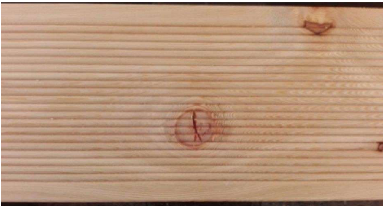
Foto 21 – ein aufgerissener, herausbröckelter Ast
