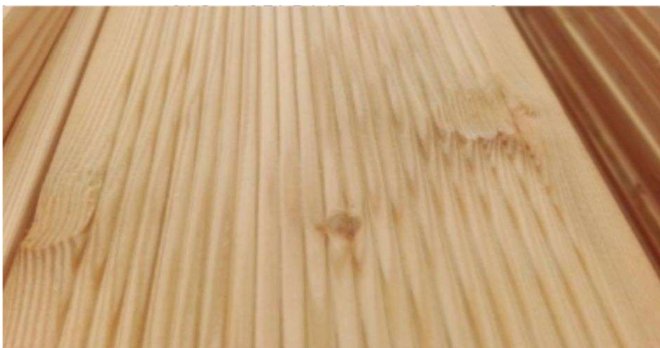
Foto 22 – entrissene Holzfasern während der Holzaufbereitung
