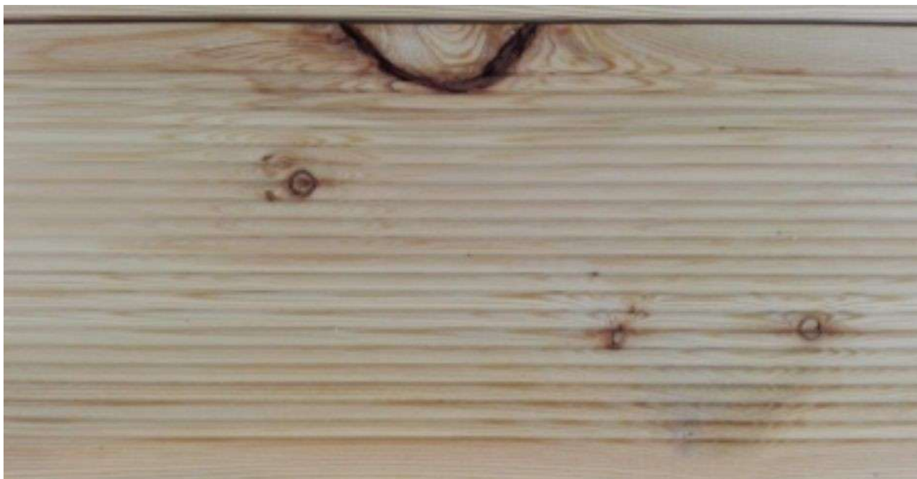
Foto 15 – ein seitlich gelegener Ast mit der eingewachsenen Rinde
