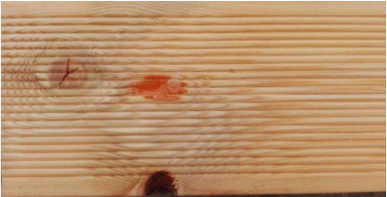
Foto 17 – ein ausgefallener Ast und Harzkammer im Querschnitt
