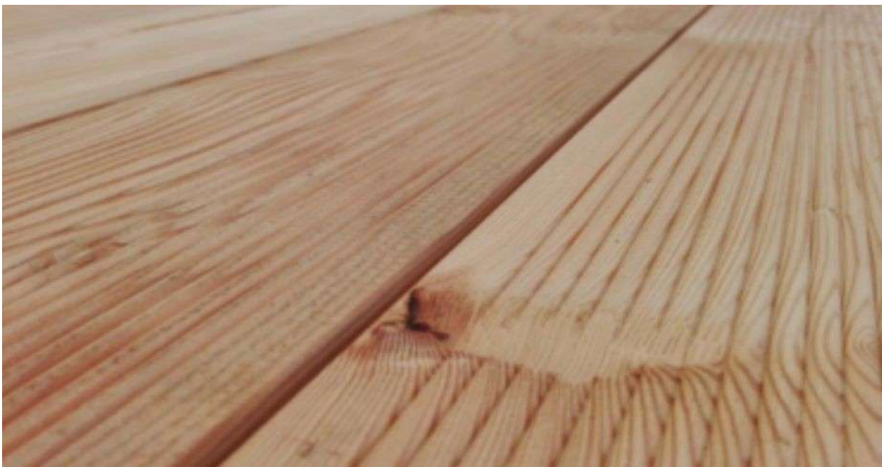
Foto 22 – ein gebrochener, abgesplitteter Ast
