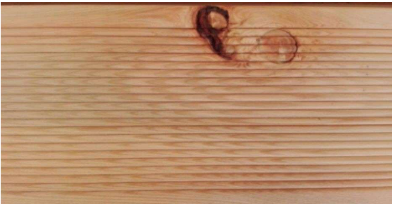
Foto 20 – Rindeneinwuchs, eingewachsene Rinde
