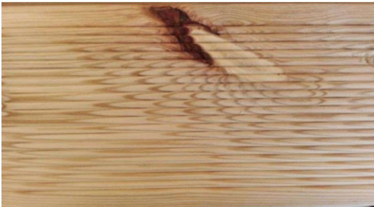
Foto 13 – Ast mit der eingewachsenen Rinde
